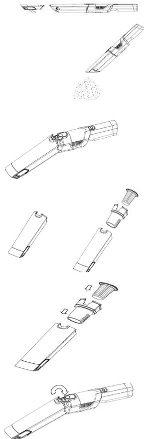
1. Drücken Sie die Entriegelungstaste (D), öffnen Sie die untere Abdeckung und entleeren Sie den Behälter.
