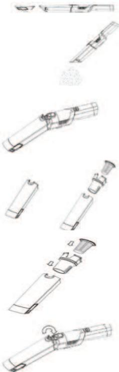
1. Drücken Sie die Entriegelungstaste (D), öffnen Sie die untere Abdeckung und entleeren Sie den Behälter.
