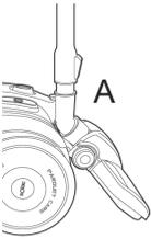
Verwenden Sie den Parkhalter der Bodensaugdüse **(A)**, um das Saugrohr in Arbeitspausen sicher zu arretieren. Stecken Sie hierzu den Parkhalter der Bodensaugdüse in die Düsenhalterung an der Rückseite des Gerätes.
