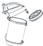
Wenn der Staubbehälter voll ist und/oder die Filter verstopft sind, reduziert sich die Saugleistung. In diesem Fall Staubbehälter entleeren und die Filter waschen, austauschen oder die Verstopfung beseitigen. Nehmen Sie ihren Staubsauger immer nur dann in Betrieb, wenn der Staubbehälter eingesetzt ist. Wenn Sie bei max. Betriebsleistung bemerken, dass die Saugleistung nachlässt, bitte den Staubbehälter entleeren.
