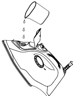
Bevor Sie den Wasserbehälter füllen, ziehen Sie den Netzstecker ab. Halten Sie das Dampfbügeleisen waagerecht. Füllen Sie es langsam mit Wasser. Um eine Überfüllung zu vermeiden, beachten Sie die Markierung am Behälter.
