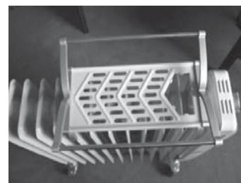
Metallrohre in die Löcher am Plastikhalter einstecken.
