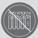
Um eine Überhitzung des Gerätes zu vermeiden, darf das Heizgerät nicht abgedeckt werden.
